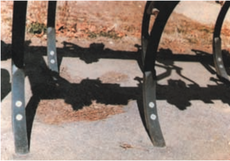
شکل ۲-۶ - گاو آهن قلمی و محل نصب تیغه‌ها روی بازوها
