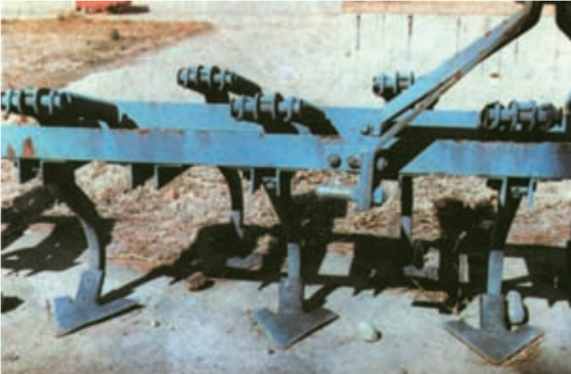
شکل ۵-۶- کولتیواتور فندار با تیغه پنجه‌غازی
